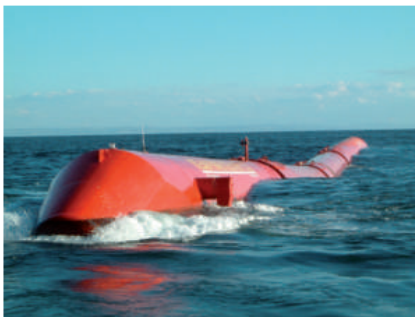
Ilustracija 8 Pogled na HEMV Aguacadora tijekom radova na održavanju
