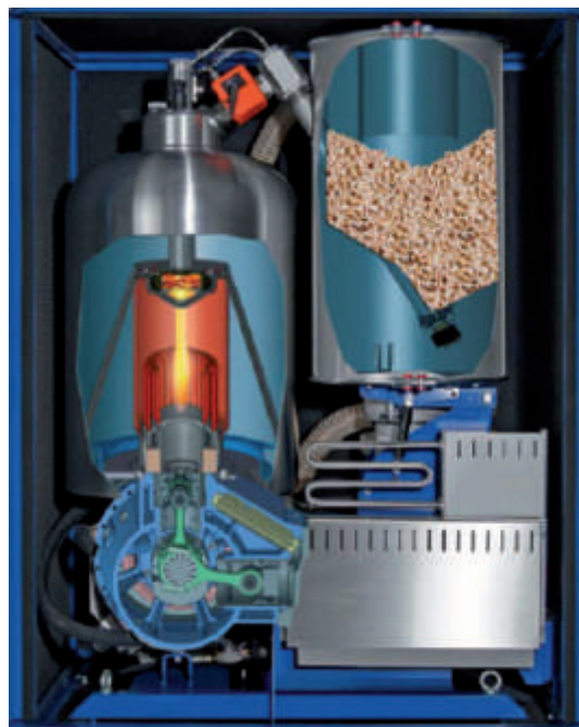
Ilustracija 4 Kompaktni sustav za mikrokogeneraciju sa Stirlingovim motorom s pogonom na pelete za pripremu PTV-a i grijanje zraka ili vode proizvođača SunMachine (električna snaga: 3,5 kW, toplinski učin: 14,5 kW)
