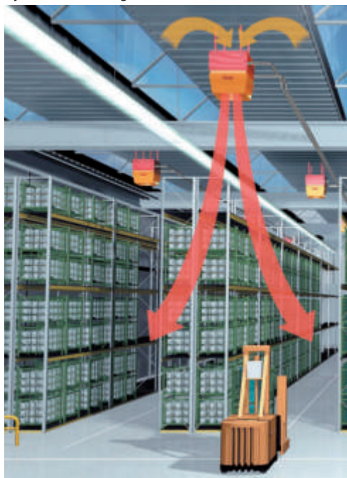
Ilustracija 5 Raspodjela zraka primjenom zračnih injektora u visokoregalnom skladištu
